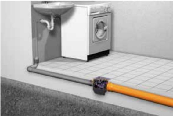
*Drehfix* ist ein wendiger Kellerablauf mit integriertem Rückstauverschluss (Typ 5). Er schützt einzelne Ablaufstellen wie Waschbecken, Dusche oder Waschmaschine vor fäkalienfreiem Abwasser aus dem Kanal nach DIN EN 13564. Wegen seiner kompakten Abmessungen passt der *Drehfix* in die Aussparung alter Gussabläufe und ist damit ideal für die Sanierung.
